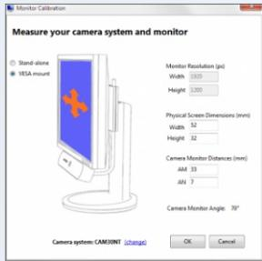
Im Dual-Monitor Betrieb muss die Kamera am Primärmonitor befestigt werden!
